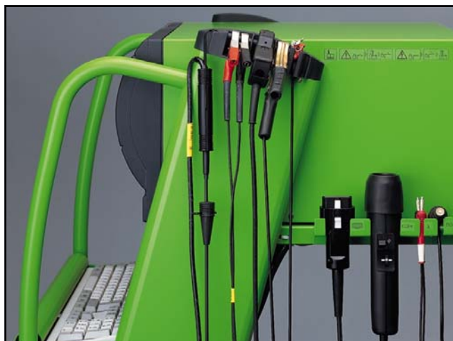
Sl. 4: Mjerni senzori modula DTM
