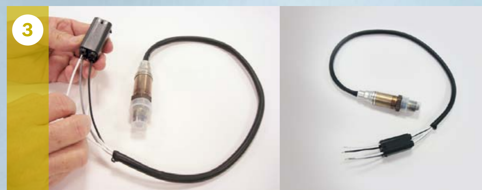
3 Umetnite kabele u plastičnu zaštitu koja dolazi s novom sondom
